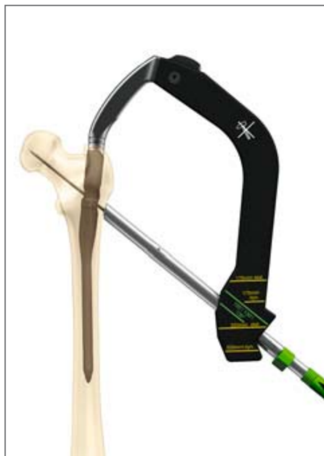
Längenmessung der TeleScrew gegen Bohrhülse
