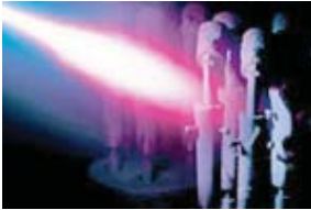
Beschichtung des Prothesenschafts
