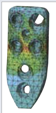
Spannungsspitzen in Platte und Hülsen
