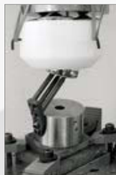
Aufbau des biomechanischen Labortests mit Targon® FN
