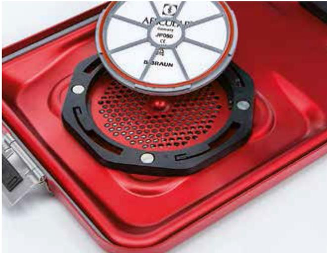
Aesculap permanentes Keimrückhaltesystem aus PTFE (Polytetrafluorethylen) für 5.000 Sterilisationszyklen validiert nach EN 868-8, Anhang H für eine lebenslange Funktion (im alltäglichen Krankeneinsatz). Ein Filterwechsel ist somit üblicherweise nicht notwendig, dies spart Zeit und Prozesskosten. Für die Dampfsterilisation in einem nach EN ISO17665-1 validierten fraktionieren Vakuumverfahren. Integriert in den PRIMELine® PRO Sterilcontainerdeckel.
