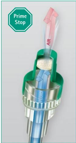
PrimeStop-Schutzkappe am Ende der Leitung: Die in die PrimeStop-Kappe integrierte hydrophobe, bakteriedichte Membran verhindert den Austritt von Flüssigkeit und sorgt für eine automatische Entlüftung der Infusionsleitung.
