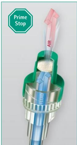
PrimeStop-Schutzkappe am Ende der Leitung: Die in die PrimeStop-Kappe integrierte hydrophobe, bakteriendichte Membran verhindert den Austritt von Flüssigkeit und sorgt für eine automatische Entlüftung der Infusionsleitung.
