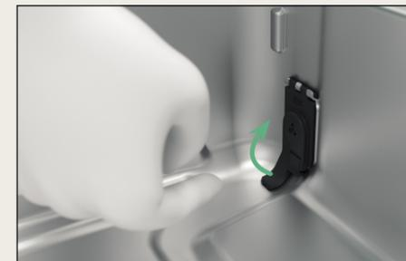
Kondensatausleitungen zur Überprüfung herausnehmen.
