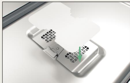
Neuen Filter einlegen (keine Knicke, Löcher, Risse).
