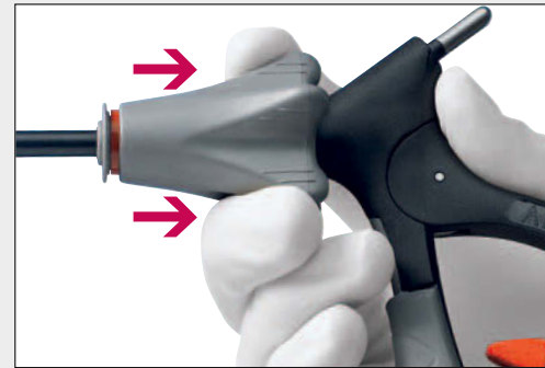
2. Schaft und Griff trennen Drehstern nach hinten schieben bis er einrastet. Ein roter Ring wird sichtbar. Wichtig: Bewegliches Griffteil nicht festhalten.
