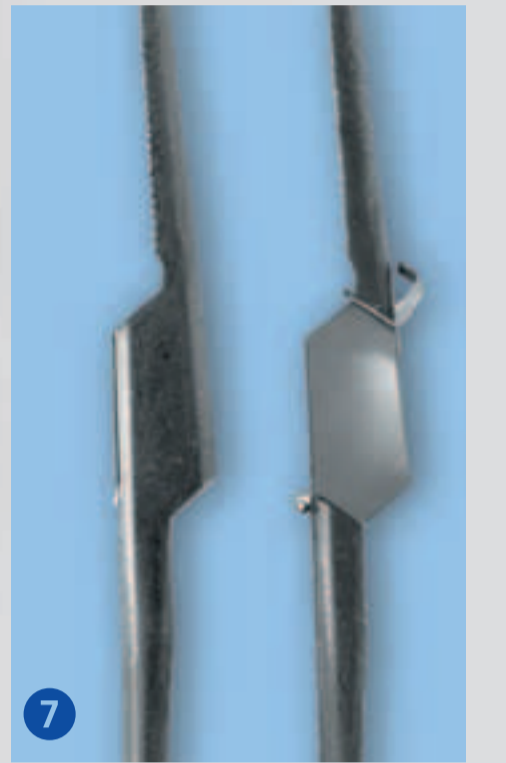
7 Kastenteil und Durchsteckteil fräsen
